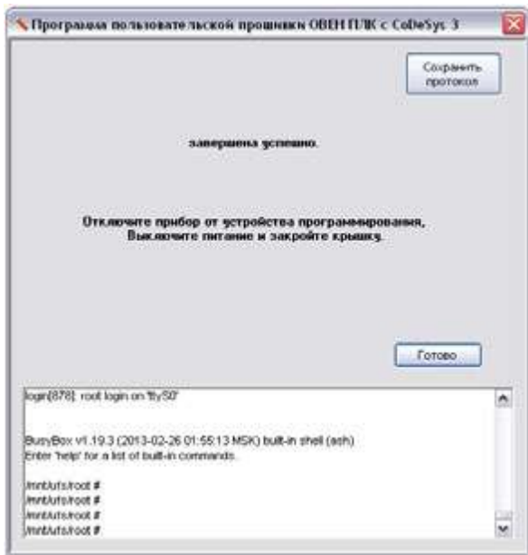
Рисунок Д.5 – Окно программы после успешного завершения процесса смены встроенного ПО ПЛК
