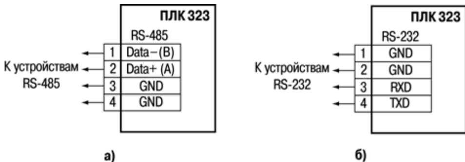
Рисунок Б.2 – Схема подключения интерфейсов RS-485 и RS-232
